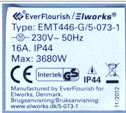
Eksempel på angivelse af en kapslingsklasse på et tænd/sluk ur.
