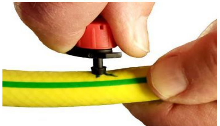
Tryk drypperen ned i hullet. Træk lidt tilbage og drej rundt for at fjerne evt. grater på indersiden.
