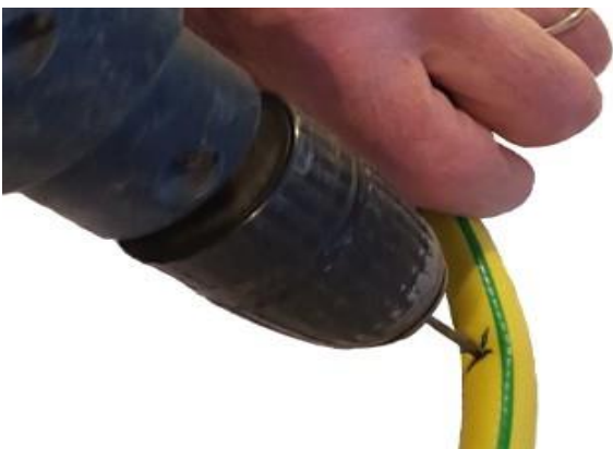
1. Mærk op, hvor der skal sidde en drypper. Bor et hul med en diameter på 3,0 mm.
